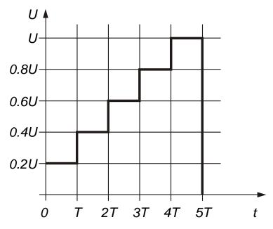
Fig. 23. Step-up test voltage
